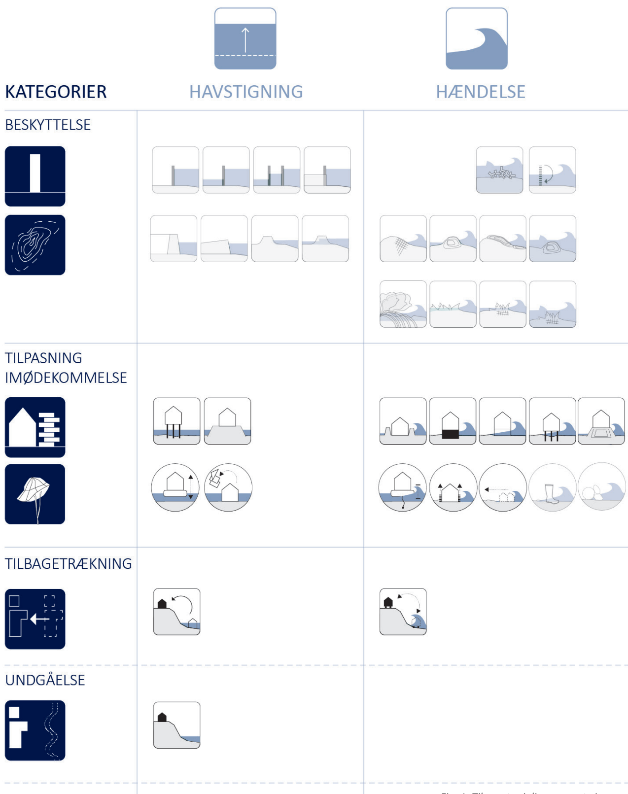
Fig. 1: Til venstre i diagrammet vises grundlæggende kategorier inden for klimatilpasning til stigende havvand; beskyttelse, tilpasning/imødekommelse, tilbagetrækning, undgåelse. De lyseblå piktogrammer viser typologier som f.eks. diger og bygningstypologier. Disse er indplaceret ud fra, hvorvidt de principielt kan imødekomme stormfloder (til et vist niveau) samt, hvorvidt de kan eksistere med en permanent stigning i det relative havvandspejl. Piktogrammer i cirkler er dynamiske bygningstypologier.
